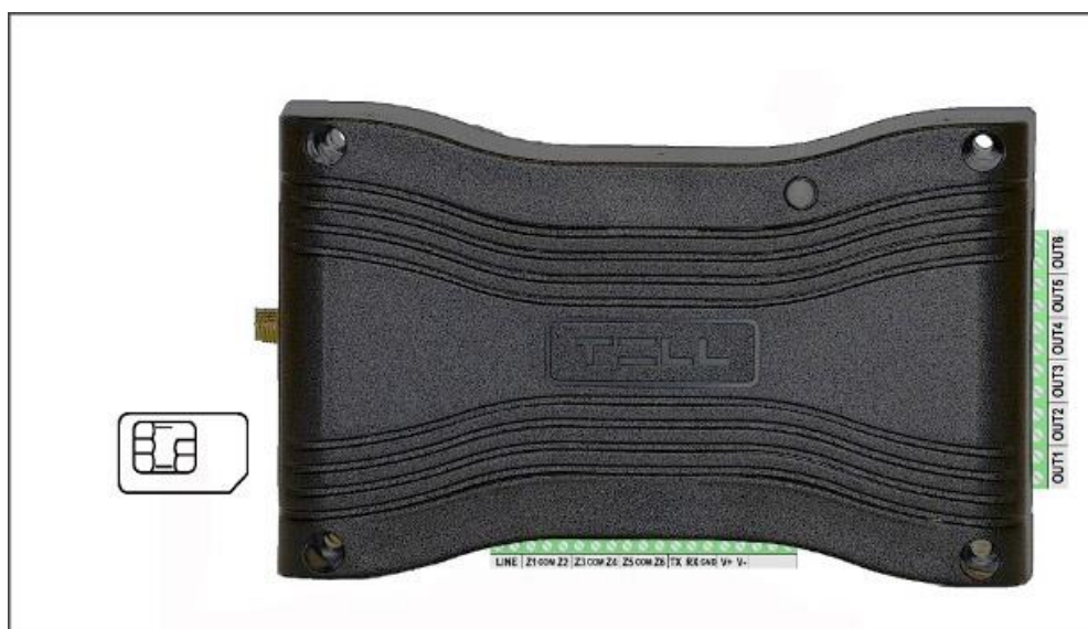
3. ábra SIM kártya behelyezése
